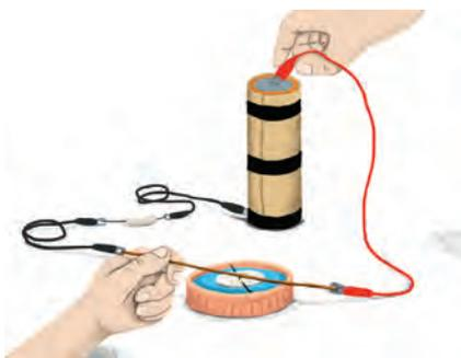
**4** Prova ora mettendo il filo di rame perpendicolarmente all'ago della bussola. Se l'hai messo bene, l'ago non girerà, anche se inverti la polarità della pila.
