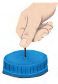
**3** Taglia un pezzo dello stuzzicadenti, per ottenere un'asticella di lunghezza compresa tra 1.2 e 1.4 cm, la quale includa una delle sue punte. Inserisci il pezzo dello stuzzicadenti nel buco del tappo, spingendolo fino a che l'estremità senza punta sia al livello della
