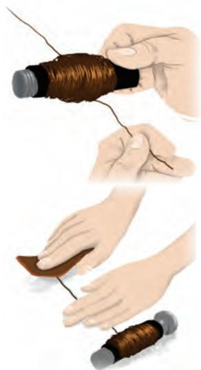
Quando avvolgi il filo, stai facendo sì che i campi magnetici generati per ogni giro si sovrappongano all'interno del nucleo ferromagnetico, il quale è un materiale che consente di essere attraversato da un campo magnetico con molta facilità.
