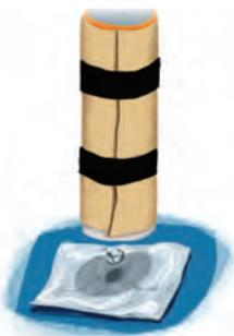
**3** Chiudi la spilla da balia intorno alla base a vite della lampadina; assicurati che il metallo della spilla sia in contatto con quello della vite. Usa il nastro adesivo isolante per fissare il cilindro di pile e il suo supporto di carta stagnola; lascia fuoriuscire un po' di carta stagnola, per poterci collegare uno dei cavi da batteria. Collega l'altro estremo del cavo alla spilla da balia.
