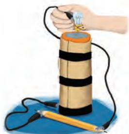
**6** Usa un cavo da batteria per inserire una delle matite piccole nel circuito della tua torcia, ma fai sì che le pinze dei cavi da batteria non vengano applicate sulla mina della matita, ma sul legno. Chiudi ancora una volta il circuito, connettendo il polo positivo delle pile con il polo libero della lampadina, e ti accorgerai che non si
