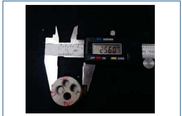
Figura 6. Muestra A: tapón de la figura 3b perforado para obtener tapones más pequeños de 3 mm de diámetro.
