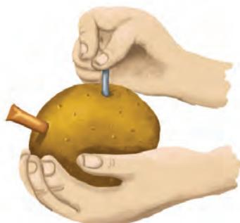
La LED sera utilisée comme détecteur et compteur relatif de la tension et de la puissance électrique de ta pile de pommes de terre, car c'est une sorte de petite bougie qui s'allume avec très peu d'énergie électrique, mais uniquement si elle est correctement branchée.
