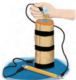
**6** Utilise un câble avec des pinces crocodiles pour insérer l'un des petits crayons dans ton circuit de lampe de poche, mais fais en sorte que les pinces crocodiles ne mordent pas les pointes du crayon mais seulement le bois. Ferme à nouveau le circuit en touchant la borne positive des piles avec le pôle libre de l'ampoule et tu remarqueras qu'elle ne
