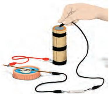
**4** Essaie de placer le fil métallique perpendiculairement à l'aiguille de la boussole. Si tu l'as fait correctement, il ne tournera pas, même si tu inverses la polarité de la pile.
