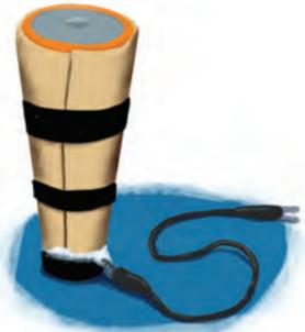
**4** Tu as pratiquement construit une lampe de poche avec deux piles en série, et pour la tester il te suffit de fermer le circuit en touchant la borne positive de tes piles avec l'autre pôle de la petite ampoule qui est en dessous de la vis. Veille à ce que le contact ne soit pas avec la vis de l'ampoule ou avec l'épingle de sûreté car tu ferais un court-circuit. Tu peux couvrir
