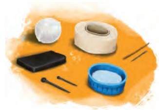
du petit clou soit légèrement inférieure à celle du cure-dent et l'épaisseur du grand clou légèrement supérieure à celle du cure-dent.
