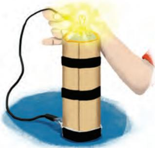
la plupart de l'épingle et de la vis avec du ruban isolant, pour t'assurer de ne pas faire de court-circuit. Si tu n'as pas laissé de faux contacts, tu remarqueras que l'ampoule s'allume à son intensité maximale.
