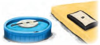
**2** Approche l'aimant de ta boussole, petit à petit et à la même hauteur que le plan de rotation de l'aiguille (utilise un support improvisé si nécessaire). Approche-le jusqu'à ce que tu remarques une déviation de l'aiguille de ta boussole. Essaie de rapprocher l'aimant des côtés restants. Tu peux voir qu'il existe des différences significatives dans la façon dont l'aiguille tourne, selon le côté de l'aimant (A ou B) orienté vers le haut.
