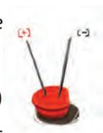
Tu dois identifier les terminaisons comme positif (+) et négatif (-), en observant la LED avec ses terminaisons vers toi. Le négatif est le plus proche du côté plat à la base de la LED, tandis que le positif est plus proche de la partie circulaire de la base. Tu dois également prendre en compte que la LED s'allume normalement avec 2 volts et 0,015 ampères de courant, bien qu'elle puisse s'allumer faiblement avec 1,5 volts et un courant plus faible.
