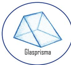
Wenn ein weißer Lichtstrahl (oder Sonnenstrahl) durch ein Glasprisma fällt, zerfällt der Strahl in mehrere Farben.
