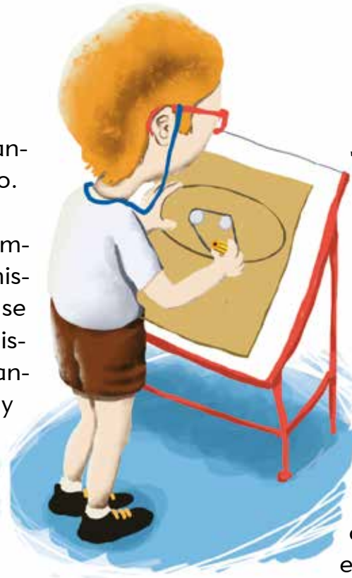
Figura 1. Cómo trazar una elipse con dos clavos, un hilo y un lápiz.
