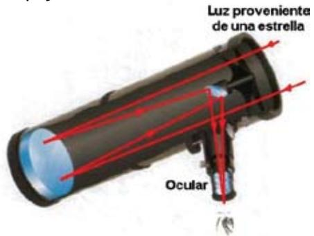
Esquema de la luz proveniente de un objeto muy lejano, por ejemplo de una estrella. La luz incide sobre un espejo situado en la parte trasera del telescopio y se refleja hacia un espejo más pequeño. Después la luz pasa a través de un conjunto de lentes, llamado ocular, para así formar una imagen del objeto lejano en el ojo del observador.
