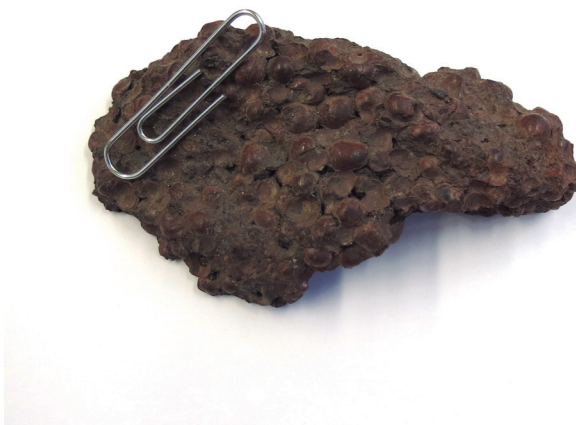
Una roca con magnetita. Se nota la capacidad para atraer objetos de hierro.
