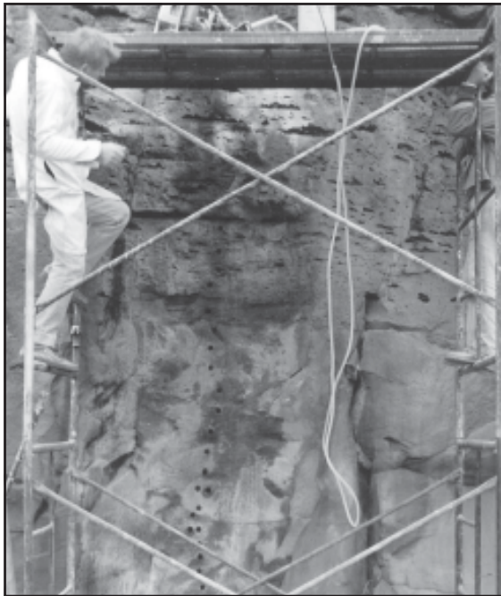
Recuperación de núcleos para mediciones paleomagnéticas de un flujo de lava del Volcán Xitle en Cd. Universitaria. Fotografía: Harald Bohnel.
